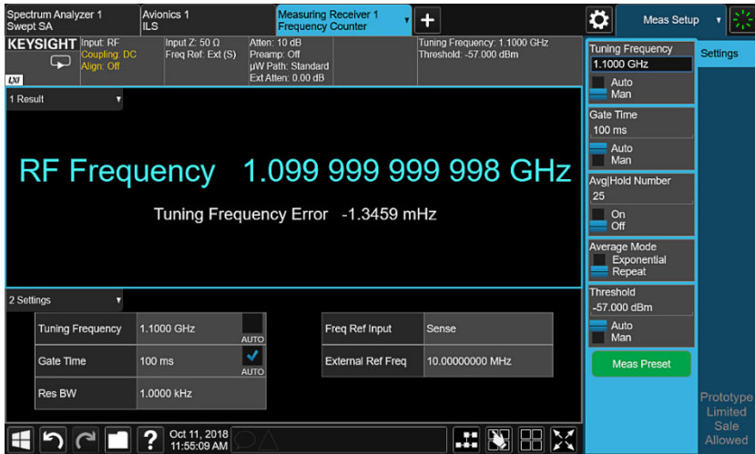
Рис. 2. Экран частотомера для высокоточного измерения частоты.
