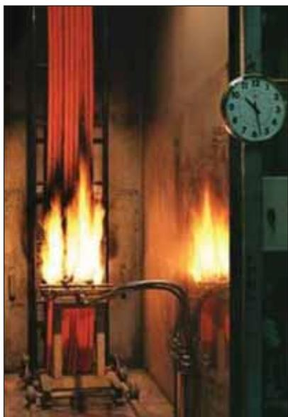
Испытание на огнестойкость согласно МЭК 60332-3.
