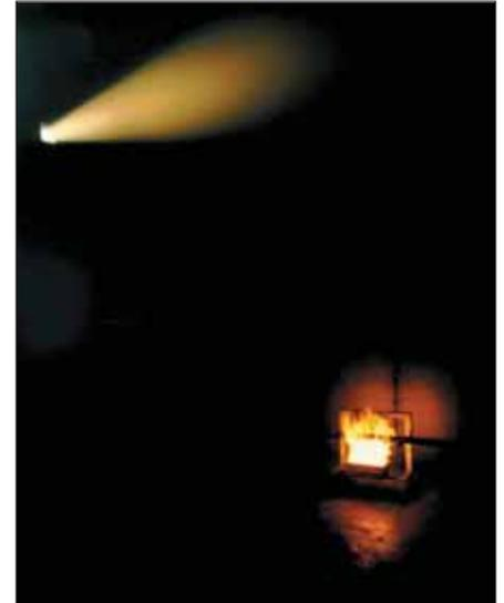
Испытание на непроницаемость дыма согласно МЭК 61034 в испытательной камере 27м3
